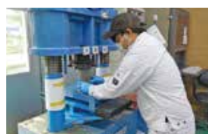
■コンクリート圧縮強度試験
