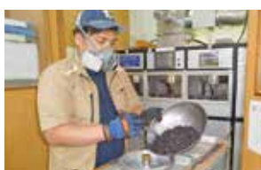
■アスファルト分離抽出試験
