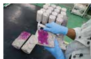
■コンクリート中性化試験
