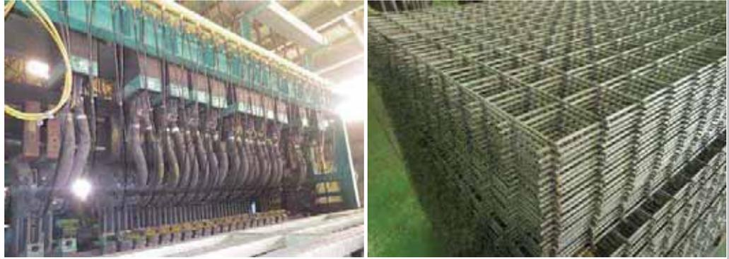
原料から製品まで一貫した品質保証体制のもとで生産し、コンクリート構造物の亀裂の発生を防ぐ。普及品以外にも用途に応じた寸法で生産は可
