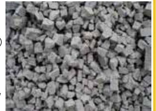
スーパーソルは軽量の土木資材として全国各地で使用されています。主には擁壁の裏込め材・軟弱地盤上の盛土材・橋台背面の裏込め材・既設構造物上の盛土などの現場で有効活用されています。
