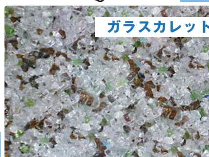
家庭から発生する空き瓶や廃ガラスは、破碎装置によってガラスカレットに変わります。その後、粉碎装置によって微粉末まで細かくされます。
