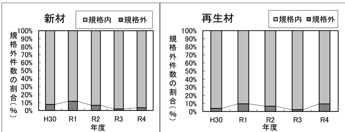
図 3.1.14 年度別路盤材試験の規格外件数の割合
