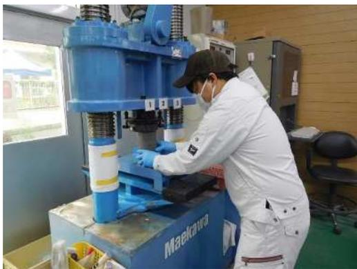
写真-3 コンクリートの圧縮強度試験
