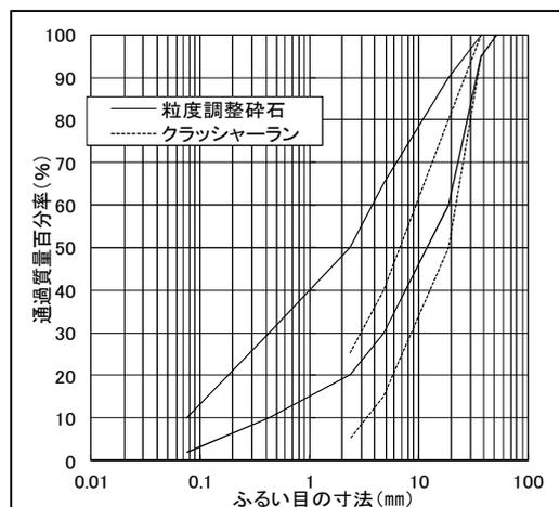
図 3.1.12 粒状路盤材料の粒度規格
