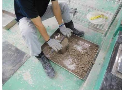
写真-2 路盤材の締固め試験
