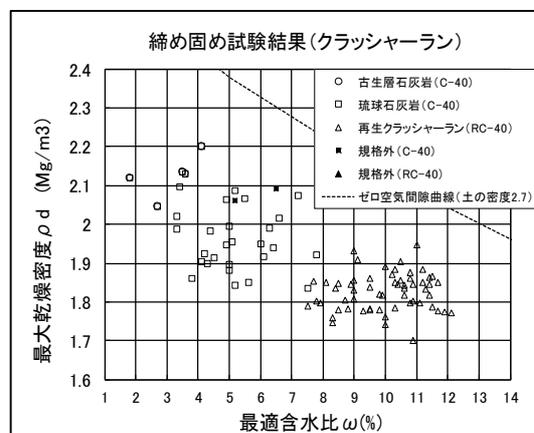
図 3.1.18 C-40 の締め固め試験結果
