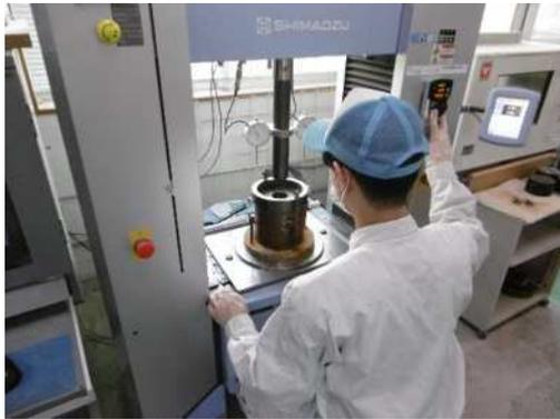
写真-1 修正 CBR 試験
