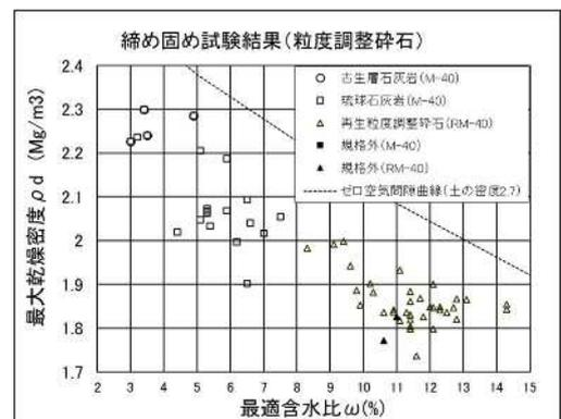
図 3.1.15 M-40 の締め固め試験結果
