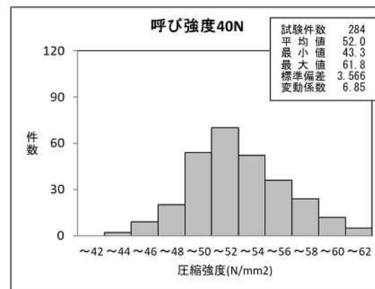
図 3.1.8 呼び強度別圧縮強度の分布図
