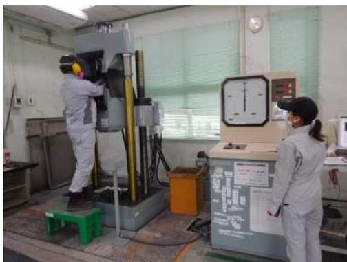
写真-5 鋼材の引張り強度試験
