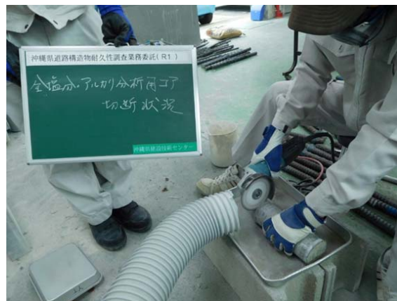
写真 3 室内試験状況（コア切断）
