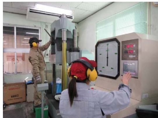
【鋼材の引張り強度試験】
