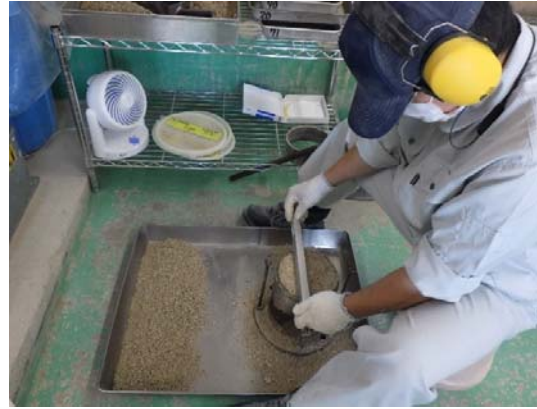
【路盤材の締固め試験】
