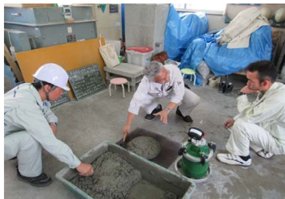
写真3 50N/mm 2 外割りFACの室内配合試験状況
