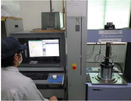
【路盤材の修正CBR試験】
