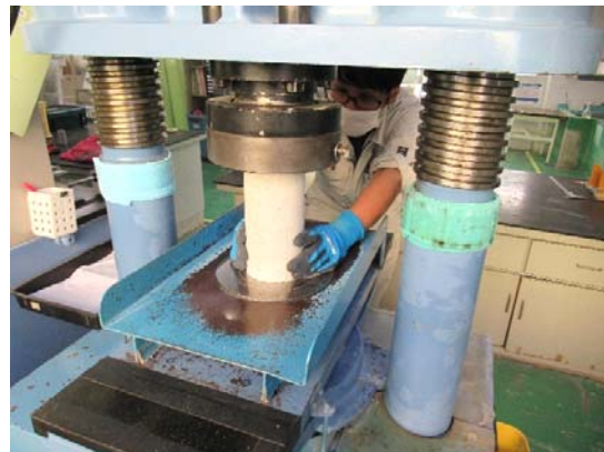
【コンクリートの圧縮強度試験】
