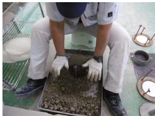
写真-2 路盤材の締固め試験
