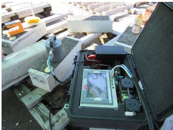
写真-11 透気係数測定状況
