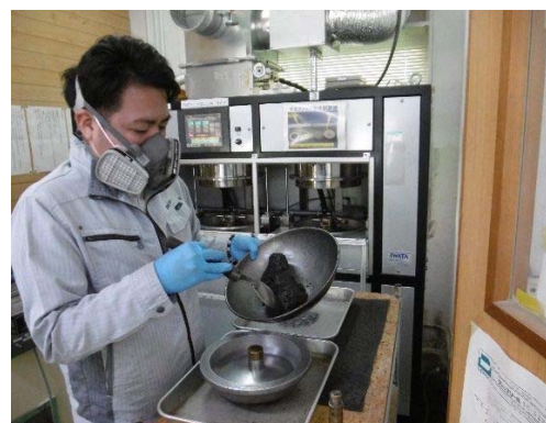
写真-6 アスファルト抽出試験
