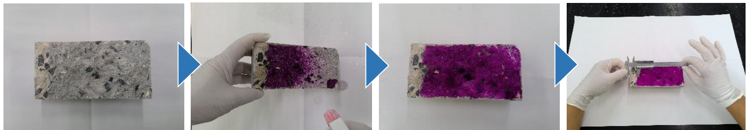
写真1 コンクリートコア割裂後から中性化深さ測定までの流れ
