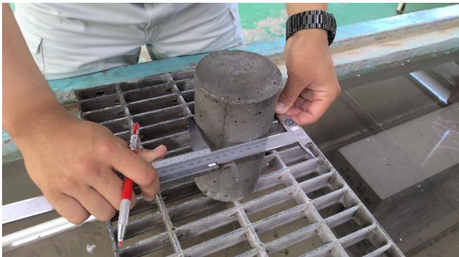
写真-1 試験前に供試体の形状を測定
