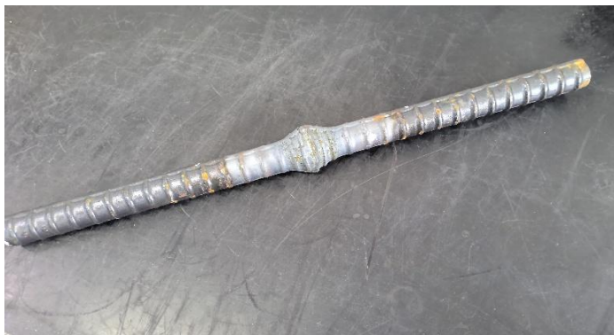
写真-1 圧接継手（右：試験前、左：試験後）
