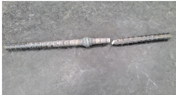
写真-1 圧接継手（右：試験前、左：試験後）
