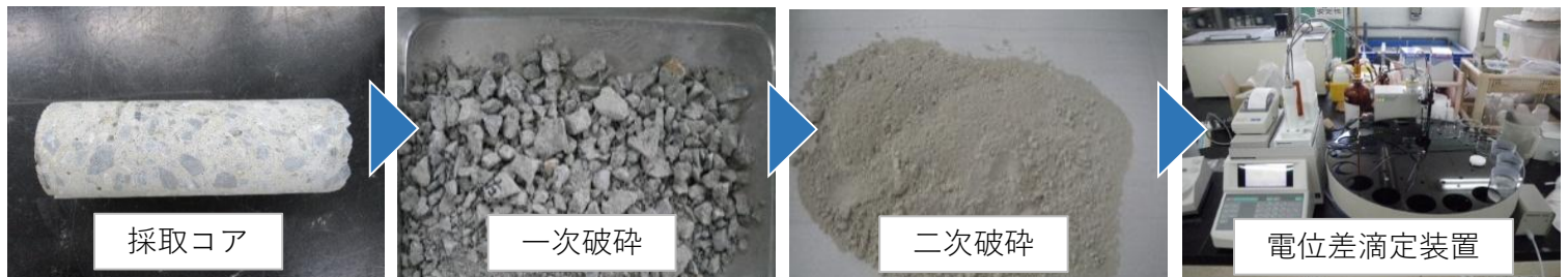
写真-1 全塩分量分析試料の作製から電位差滴定までの流れ
