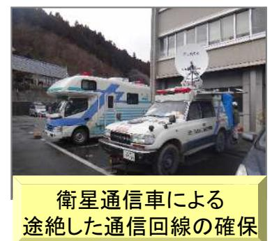
衛星通信車による途絶した通信回線の確保
