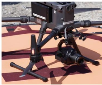
DJI Matrice 300 RTK Matrice200の後継機種 各高度機能を追加。 最大飛行時間の延長、 全方位の衝突防止機能。
