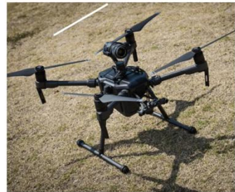
DJI Matrice 210 RTK RTK装備による 高度な測位 上方ジンバル可能。 (床版点検用等)
