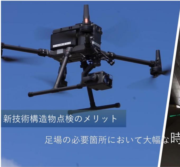
DJI Matrice 210 RTK RTK装備による 高度な測位 上方ジンバル可能。 (床版点検用等)
