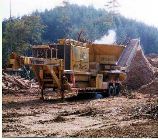
樹木をタブグラインダによりチップ化
