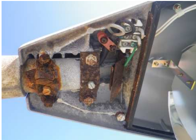
灯具取付部の異種金属接触による腐食
