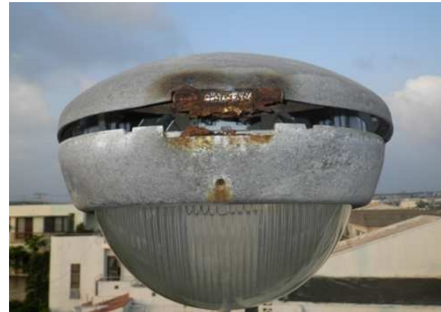
灯具開口部の異種金属接触腐食による破断
