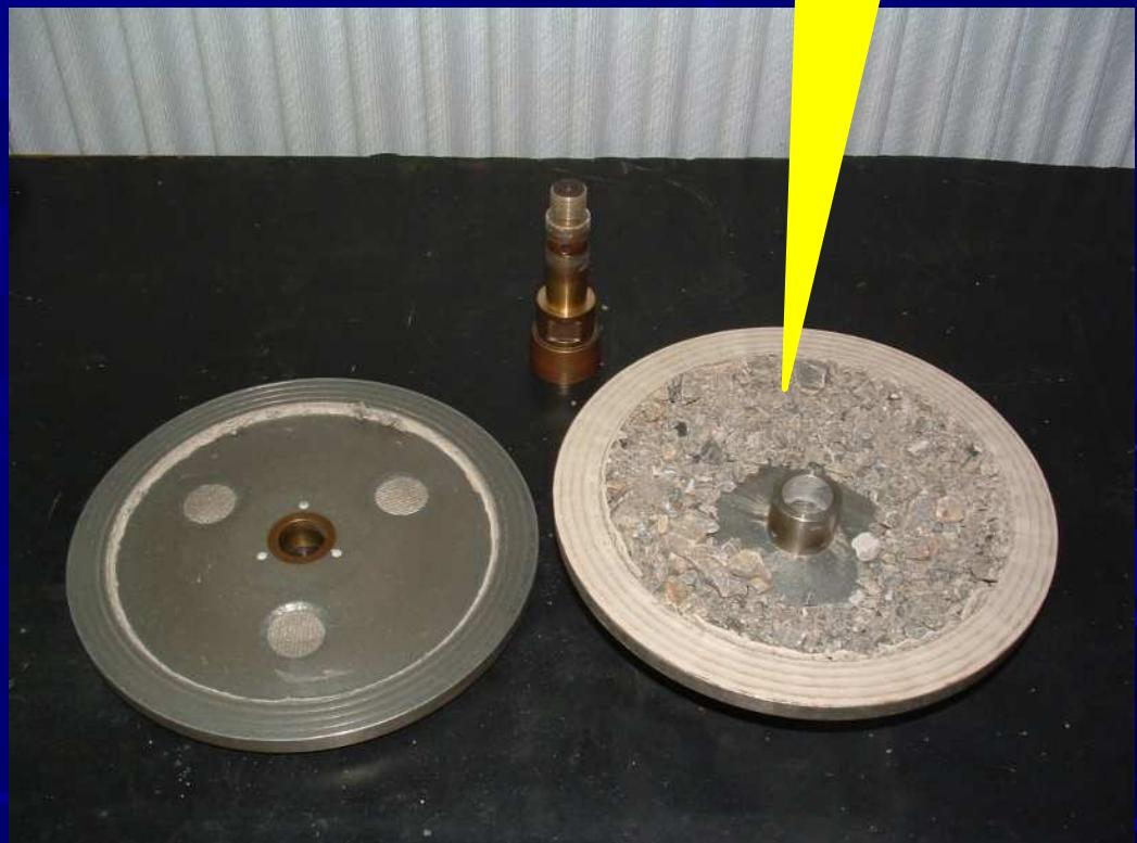
抽出前(質量) — 抽出後(質量) = 質量の差がアスファルト量
